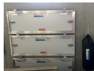
Abbildung 65: Für gefährdete Objekte in Risikogebieten sollten Sandsäcke und mobile Verschlusselemente immer griffbereit sein.
