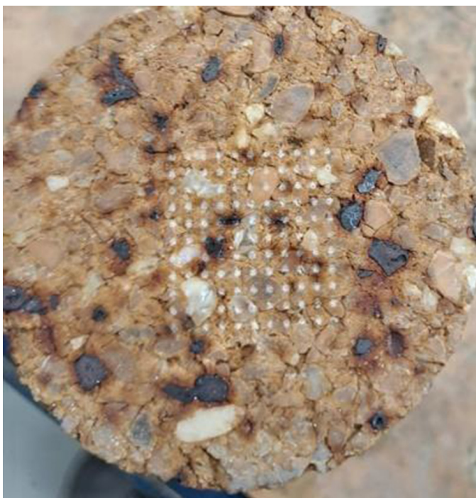
50 mm Zylinder einer Feuerfestprobe mit ersichtlichen LIBS-Messungen
