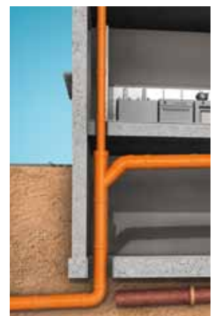
Abhängung unter der Kellerdecke und Stilllegung des alten Kanals
