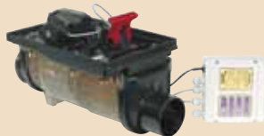
Abb. 11.4 Elektronisch gesteuerter Rückstauverschluss – erforderlich bei fäkalhaltigem Abwasser.
