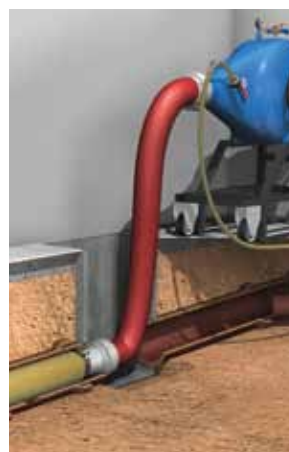
Renovierung durch Schlauchlining
