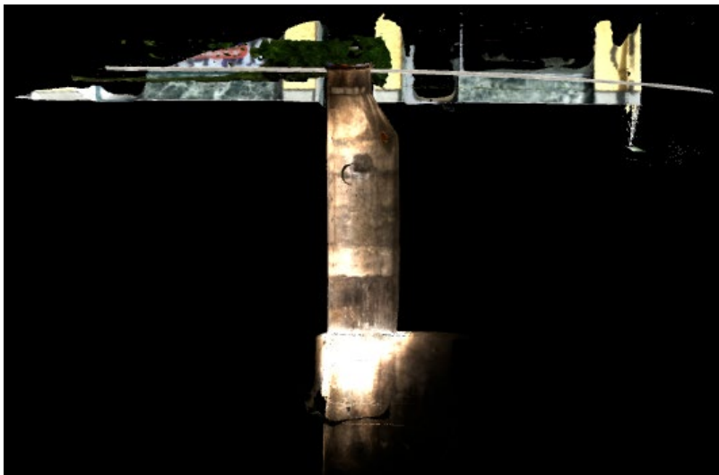
Abbildung 43: Modell einer Schachtaufnahme mit CleverScan, RHV Braunau und Umgebung
