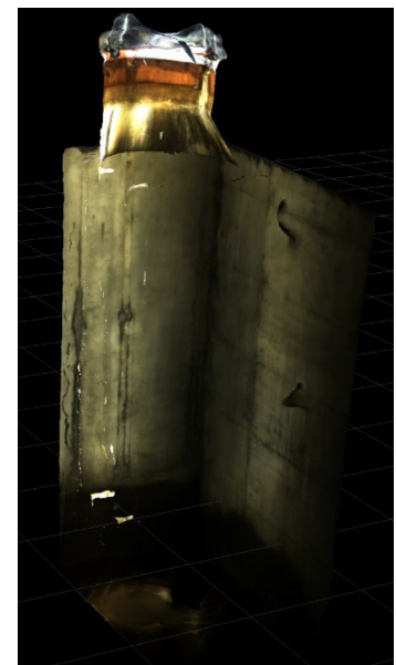
Abbildung 34: Photogrammetrisches Modell eines Einstiegsschachtes (IBE, 2020)
