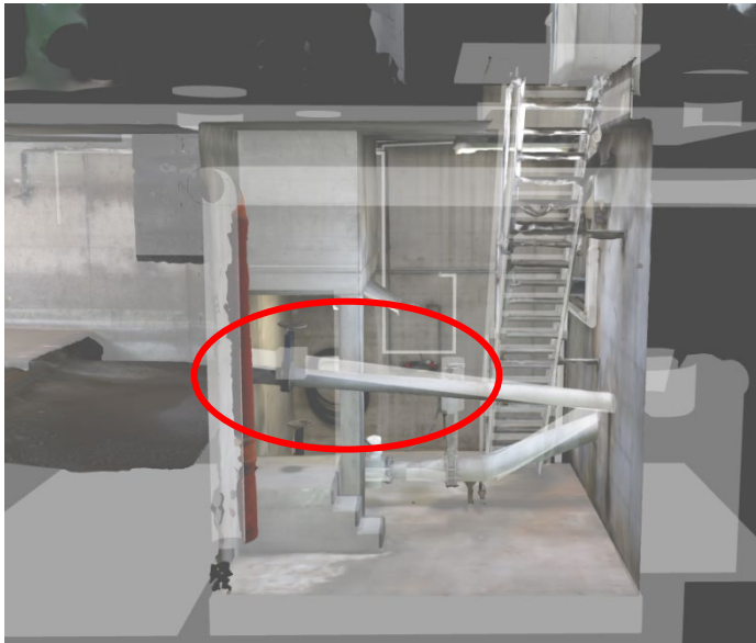
Abbildung 48: Überlagerung photogrammetrisches und 3D-Modell SBW AWW Großache-Nord
