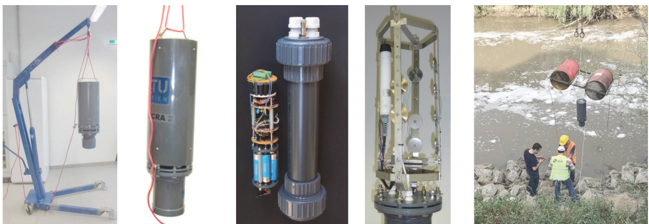
Abb. 22 Von links: Drei Bauformen von MICRA-buoy; Probenhalter mit Werkstoffproben und Referenzelektrode bestückt; MICRA-1 an einem Schwimmkörper, kurz vor der Exposition in einem Gewässer (mit Genehmigung)
