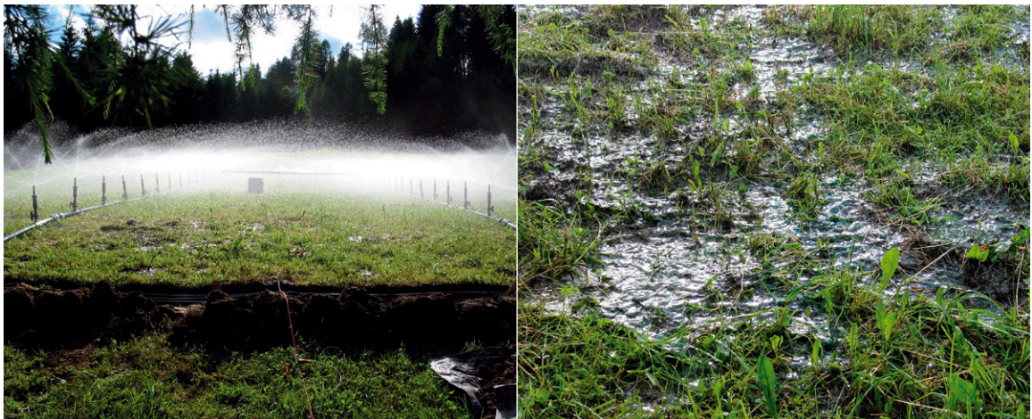
Abb. 3.7 Beregnungsexperiment und Oberflächenabfluss: Fläche 100 m 2 , Regenintensität 100 mm/h (Quelle: Bundesforschungs- und Ausbildungszentrum für Wald, Naturgefahren und Landschaft – BFW)
