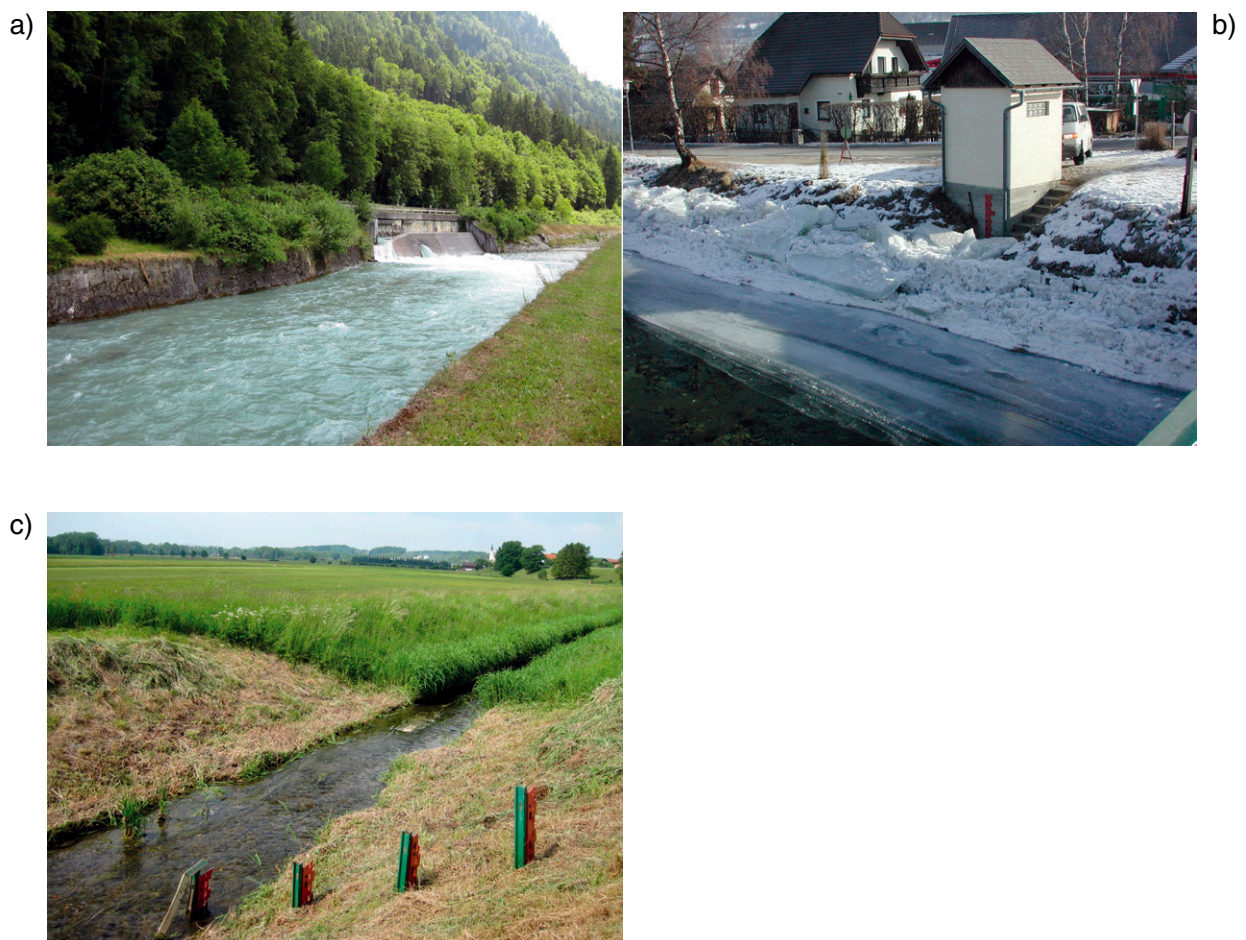
Abb. 2.26 Beeinflussungen von Abflussmessungen: (a) durch Kraftwerke, Einleitungen, Ausleitungen, Wasserfassungen – Uttendorf/Stubache, Salzburg: Einleitung KW-Kanal oberhalb der Messstelle (Foto: G. Müller, Juli 2010), (b) durch Eis – Pegel Tamsweg/Taurach, Salzburg (Foto: HD Salzburg, 8.1.2002), (c) durch Verkräutung – Untereching/Pladenbach, Salzburg (Foto: G. Müller)
