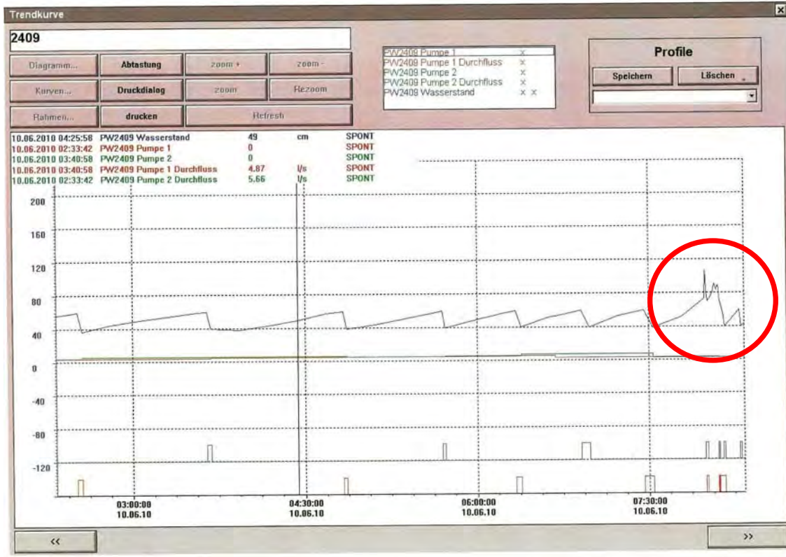
Abbildung 5-9 – Darstellung der Wasserstandsganglinie bei einer Pumpenverstopfung
