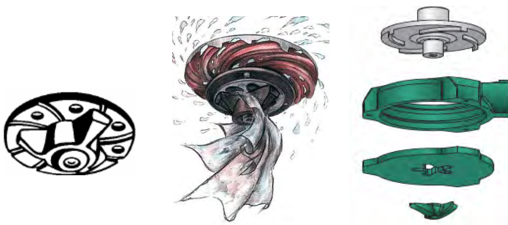
Abbildung 4-28: Laufrad mit Schneideinrichtung (JABERG, 2003; MALL, 2011; WILO, 2008)
