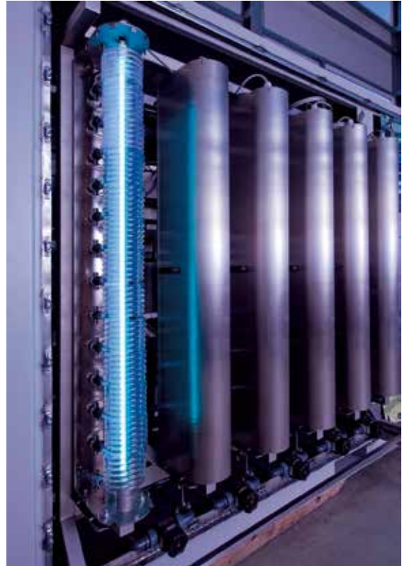
Abb. 3 Elektrochemische Zelle (links) und Wendelrohrreaktor (rechts) (Bild VTU)
