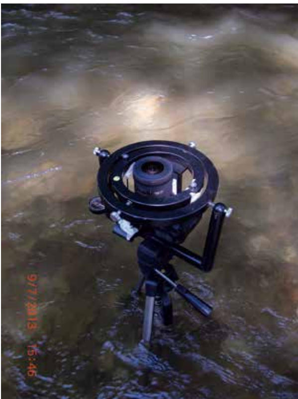
Abb. 11 Fischaugenkamera für die Messung des Beschattungsgrades (BARTEL, HLOUSEK, 2014)
