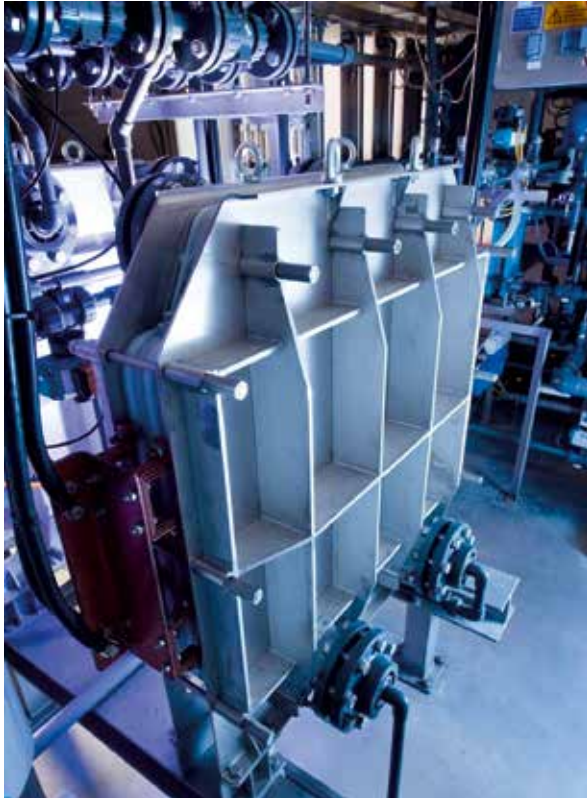
Abb. 3 Elektrochemische Zelle (links) und Wendelrohrreaktor (rechts) (Bild VTU)
