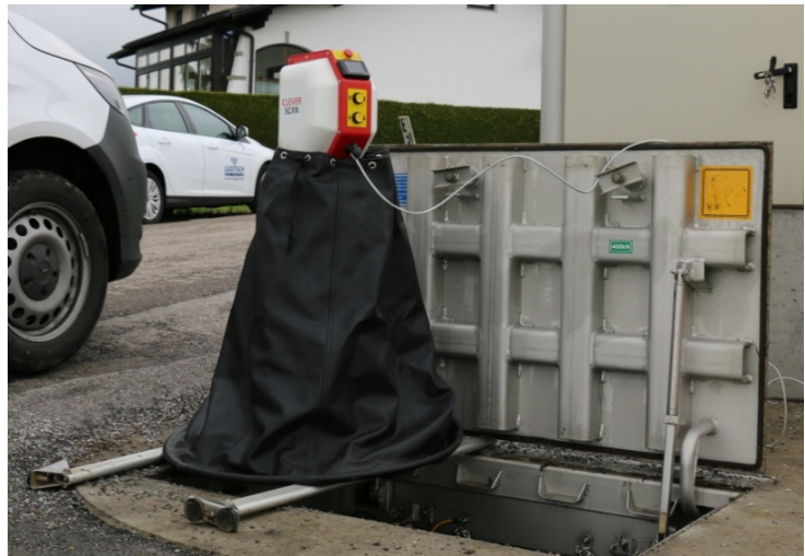
Abbildung 29: Aufstellung der CleverScan mit Hilfe von Stangen.
