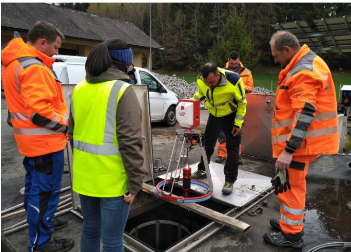
Abbildung 26: Aufstellung der CleverScan mit einer Holzlatte (links) und einer großen Abdeckplane (rechts).
